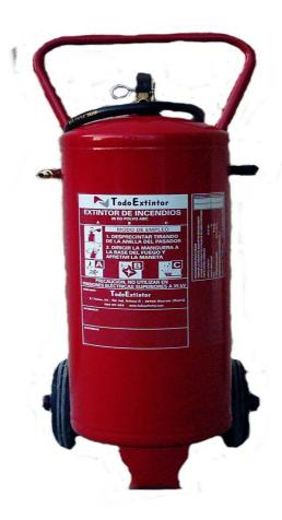
Extintor de Polvo Quimico ABC de 25 kg sobre ruedas. Incluye manómetro, válvula de disparo rápido, chasis tubular soldado al extintor con ruedas y manguera. Pintado en rojo RAL-3000. Fabricado según EN-3/96. Diámetro: 800 mm Altura: 900 mm Anchura: 235 mm (350 mm con ruedas). Peso cargado: 42,5 kg Presión de Prueba: 23 Bar.
