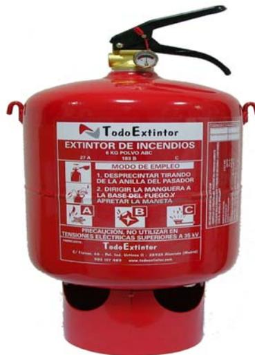
Extintor Automatico de Polvo Quimico ABC de 6 kgs (Sprinkler). Pintado en rojo RAL-3000. Completo. Incluye cadena metálica para su montaje en techo y Rociador instalado con temperatura de disparo estándar (68°C). Fabricado según EN-3/96. Incluye manómetro externo para comprobación de presión.
