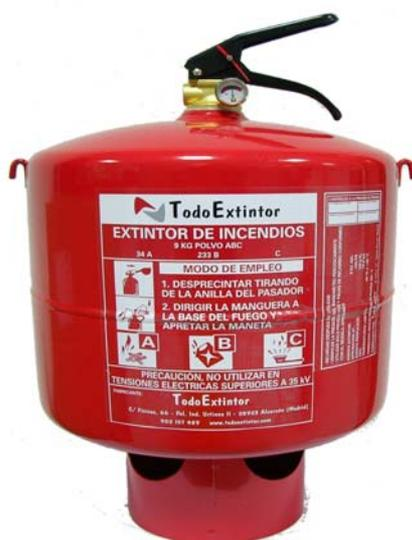
Extintor de Polvo Químico ABC Automático (Sprinkler) de 9 kgs de capacidad. Pintado en rojo RAL-3000, incluye cadena metálica para su montaje en techo y Rociador de temperatura estándar (68°C) de disparo. Equipo completo para su montaje final. Fabricado según EN-3/96. Incluye manómetro exterior para comprobación de presión.
