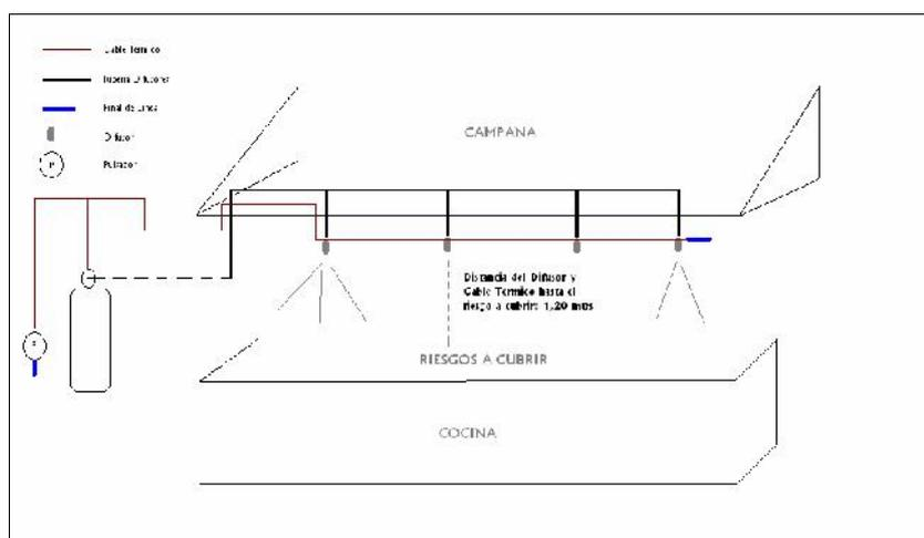
**ESQUEMA CONEXIÓN DIFUSORES Y CABLE TERMICO EN COCINAS CON FILTROS A 45° (3 OPCIONES)**
