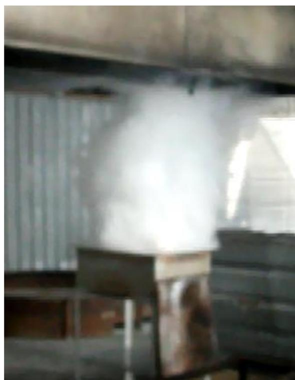
**Fig. 9: Secuencia extinción freidora (5 segundos entre fotograma inicial y final)**
