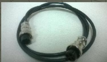
Cableado de conexión entre sistemas y de conexión a la central con 4 hilos. Sistema supervisado.
