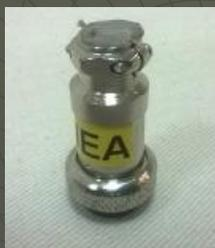
El sistema incluye un final de línea que se coloca en el último sistema y que cierra el circuito mediante una resistencia de 2K7, que se puede cambiar en caso de que el usuario así lo necesite, por otra resistencia o por un condensador. Incluye una pequeña caja donde se aloja la resistencia y que permite el cambio de la misma de manera fácil.
