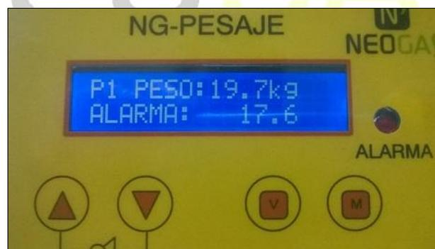
La parte que pone P1 PESO: 19.7 KG es lo que pesa el cilindro completo suspendido y este es el peso que debemos anotar para calcular posteriormente cual va a ser el peso de alarma que queremos programar.
