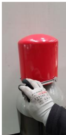
Fotografía de cuales son los tornillos a aflojar para quitar la caperuza al cilindro.
