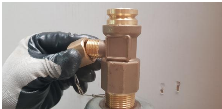
Fotografía que recoge como quitar tapon de salida de la válvula auxiliar
