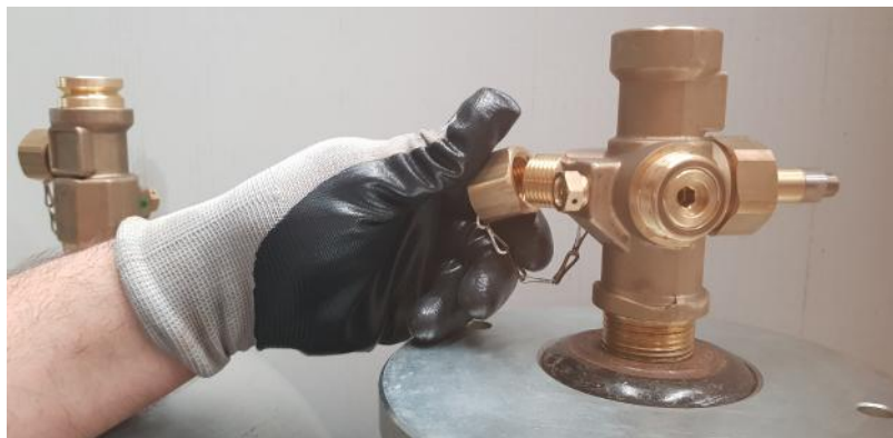
Fotografía de cómo quitar tapon de boca de salida de válvula piloto
