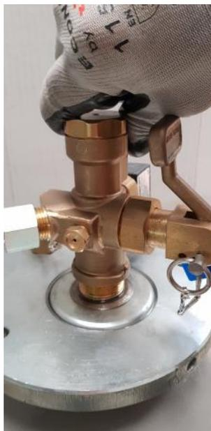
*Fotografía de cómo tiene que quedar la tapa superior de la válvula una vez es roscada manualmente en la válvula.*
