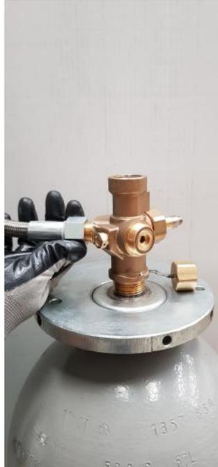
*Fotografía de cómo roscar el latiguillo de salida de gas a la boca de salida de gas.*
