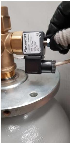
*Fotografía de colocación de la bobina conectada en la solenoide de la válvula.*
