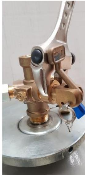
*Fotografía de cómo apretar con llave el sistema de disparo a su correspondiente puerto en la válvula.*
