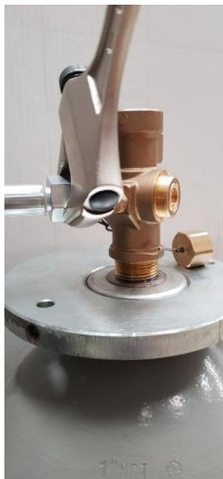
*Fotografía de cómo apretar con llave el latiguillo de salida de gas a la boca de salida de gas.*
