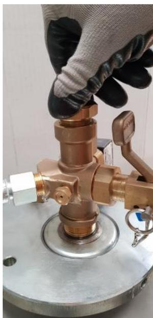
*Fotografía de cómo roscar manualmente la tapa superior de la válvula anteriormente quitada.*
