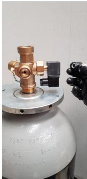
*Fotografía de cómo quitar la tuerca de la bobina electroimán de la válvula y luego sacar la bobina de la solenoide de la válvula para su manipulación.*
