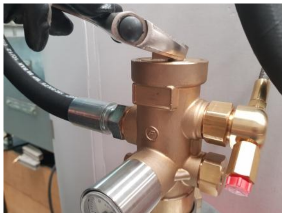
Fotografía de cómo apretar con llave la tapa superior de la válvula auxiliar anteriormente quitada.
