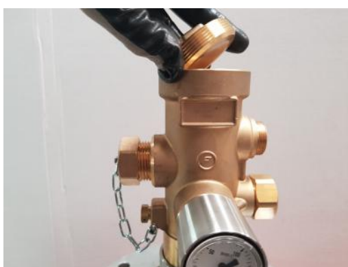
Fotografía de cómo quitar la tapa superior de la válvula
