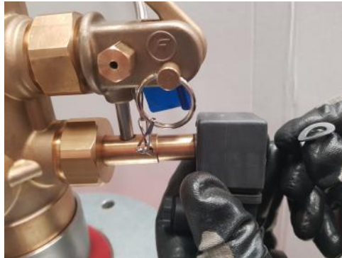
Fotografía de cómo quitar la tuerca de la bobina electroimán de la válvula.
