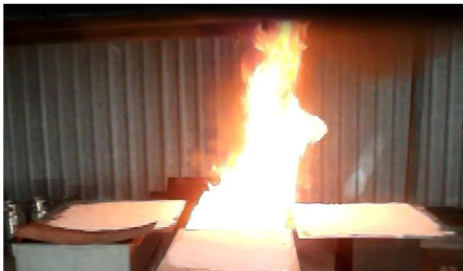
**Fig. 11: Ensayo salpicadura en freidora (inmediatamente anterior al inicio de descarga)**
