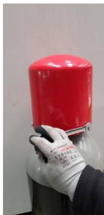
Fotografía de cuales son los tornillos a aflojar para quitar la caperuza al cilindro.
