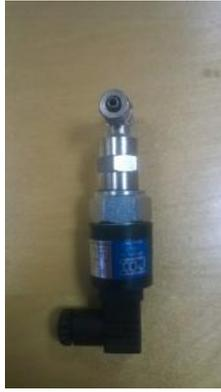
**Presostato de señalización de maniobra para sistema FIRE-TEX-ES (opcional para colocar en línea de disparo de botellines de co2)**
