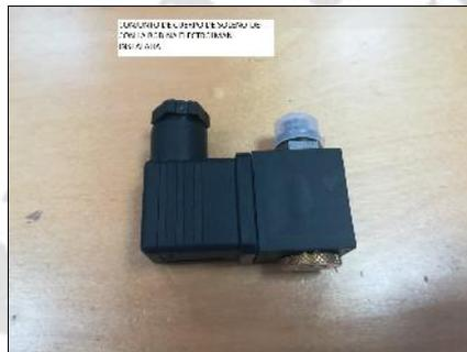
Cuando se recibe por parte del cliente el equipo, se debe de quitar la bobina de electroimán del cuerpo de la solenoide y separar ambas piezas. La forma de quitar la bobina del cuerpo es desenroscar la tuerca circular de latón que lleva el cuerpo de la solenoide con la mano y quitar la junta metálica que incluye. Posteriormente volver a roscar la tuerca circular y la junta metálica en el cuerpo de la solenoide para no perderlas.
