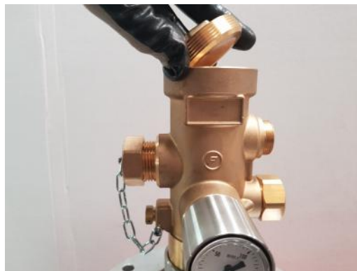
Fotografía de cómo quitar la tapa superior de la válvula
