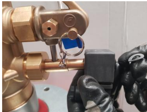
Fotografía de cómo quitar la tuerca de la bobina electroimán de la válvula.
