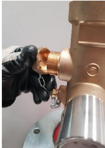
Fotografía de cómo quitar el tapón de seguridad a la boca de salida de gas.
